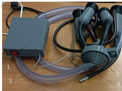
Рисунок 1 – Доильный аппарат выжимающего принципа действия 1 – электронный блок управления; 2 – доильный аппарат; 3 – молочный шланг; 4 – воздушный шланг
